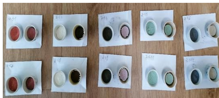
Фиг. 1 Изходни шихти и изпечени пигменти– отляво при всеки състав е шихтата, отдясно – синтезирания при 1200°C пигмент
