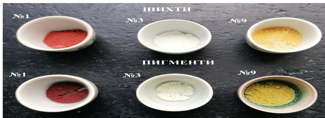
Фиг. 1. Изходни шихти (горен ред) и изпечени пигменти при 1000^{\circ}C (долен ред)
